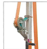
La grue est dotée d'un treuil de qualité et d'une courroie de nylon de 2".
